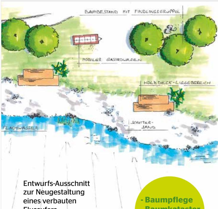
Entwurfs-Ausschnitt zur Neugestaltung eines verbauten Flussufers
